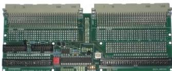
Die Kontaktierung des Prüflings und die Zuordnung (Mapping) der Prüfling-Kontakte zu den Instrumenten erfolgt auf der TA-Lab/ TA-Connect-Anschlusseinheit bzw. im Testadapter.
